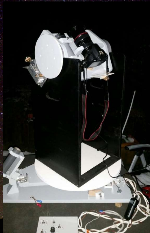
Equatoriaal platform met synchroonmotor, bereik ongeveer 40 minuten
