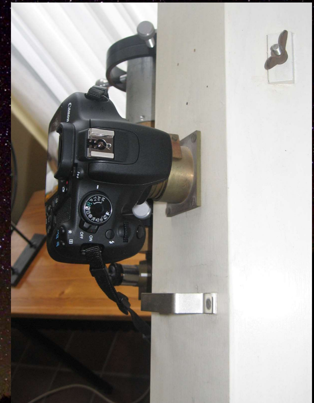
Gemodificeerde Canon 1200D DSLR in plaats van oculair, helical focuser
