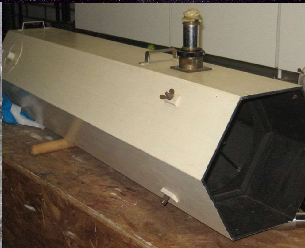
18 cm Newton telescoop Zelfbouw met zelf geslepen F/6 spiegel
